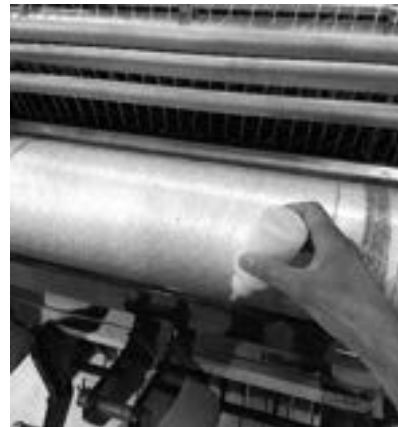
Figur 27 Påføring af talkum på forsiden af netrullen
