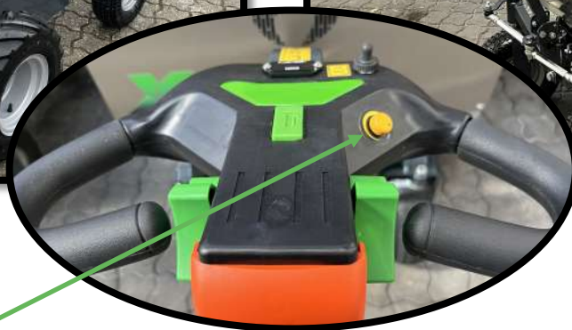
Potentiometer, der kan regulere hastigheden på el undervognen
