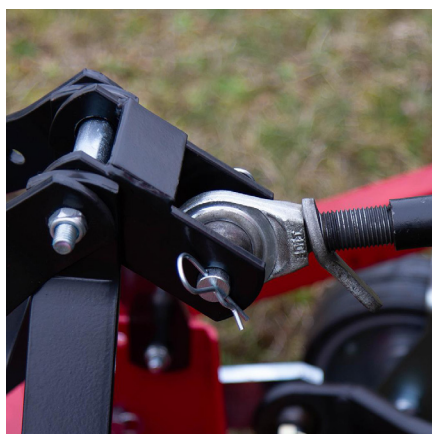
Montering af topstang
