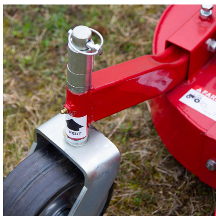
Justering af hjulhøjden ved at ombytte afstandsbøs
