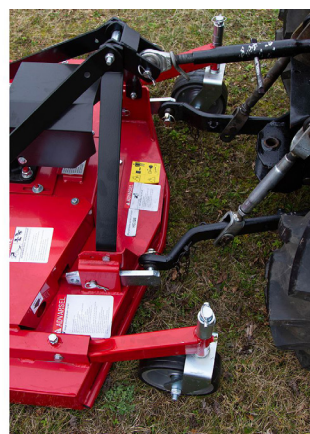
Montering af liftarme
