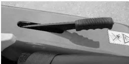
Parkeringsbremsen er frigivet i position "A"
