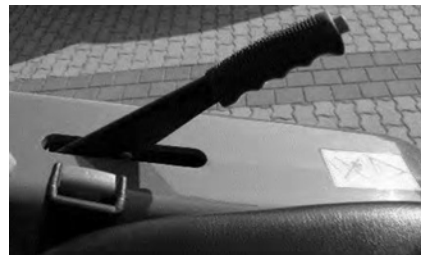
Flyt bremsehåndtaget til position "B" for at aktivere bremsen
